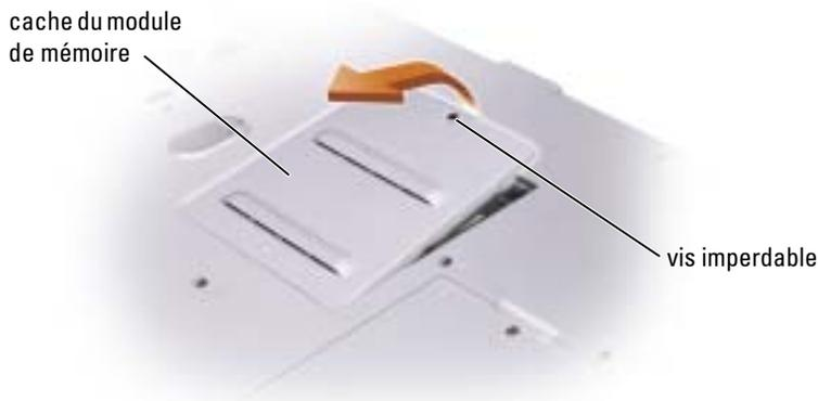
**⚠ AVIS :** Pour éviter d'endommager le connecteur du module de mémoire, n'utilisez pas d'outil pour écarter les clips de fixation du module de mémoire.
